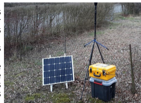
photo ci-dessus : le matériel utilisé pour les mesures (anémomètre sonique 3D) est alimenté par un panneau solaire pour une totale autonomie
